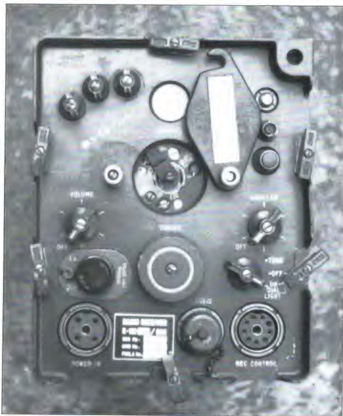
Frontaanzicht van de ontvanger, waarbij de ruitvormige afdekplaat is losgehaald. Duidelijk te zien zijn de schroeven voor de voorkeursinstelling en de schaal calibratie.
